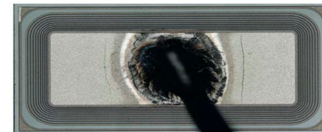
图 14: I_{FSM} 失效开封图
